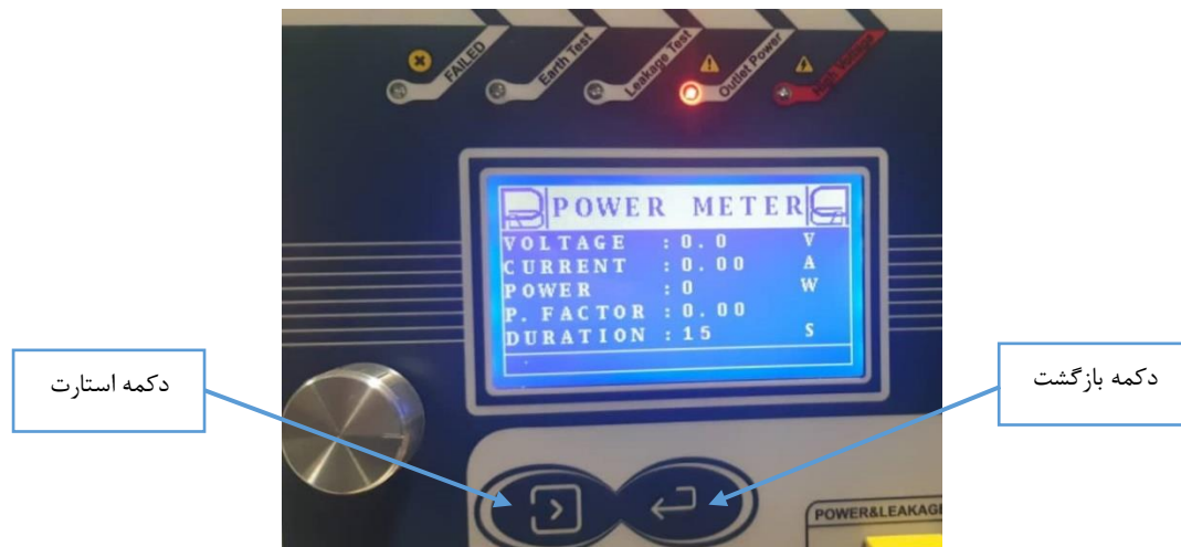
شکل ۲. ناب نمایشگر، کلید استارت، کلید بازگشت و چراغ‌های نمایشگر تست
