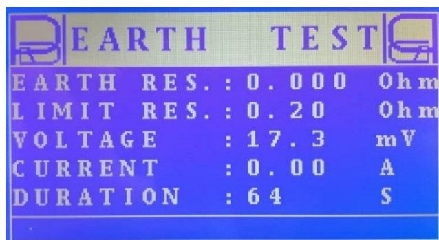
شکل ۷. آزمون مقاومت اتصال به زمین
