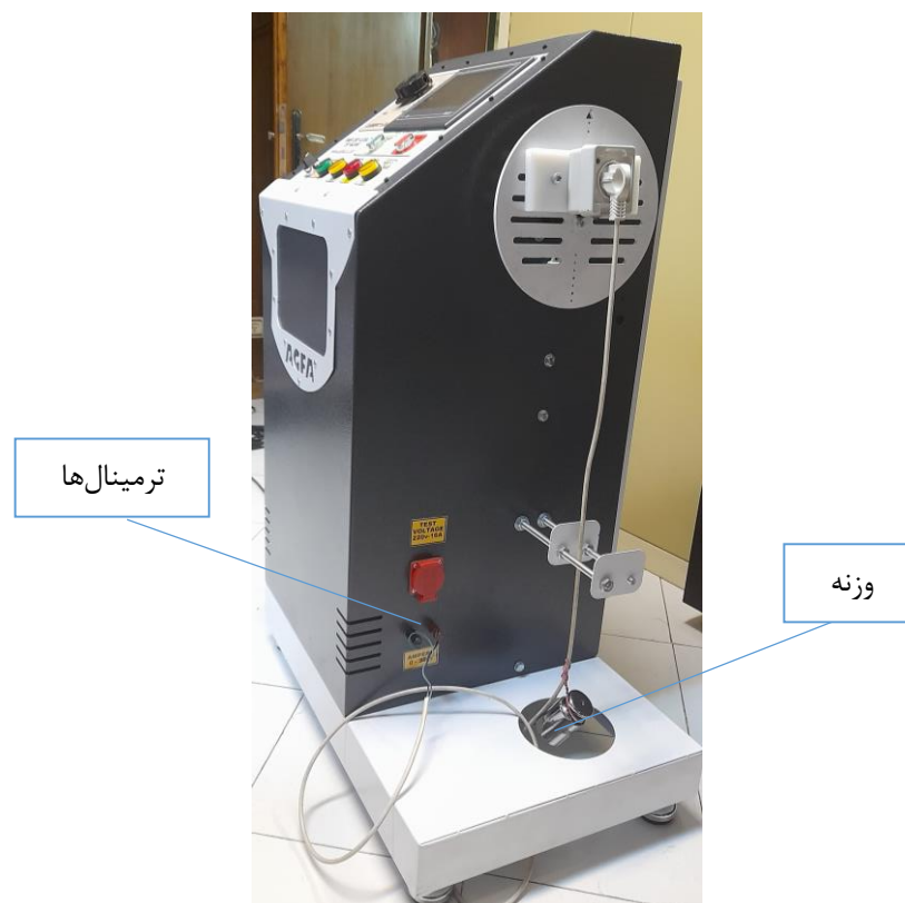
شکل ۳. نحوه بستن کابل و دوشاخه به دستگاه
