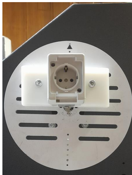
شکل ۲. نحوه بستن پریز به صفحه نوسانگر
