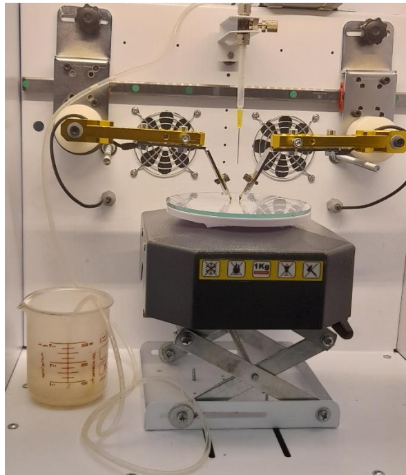
شکل ۴: نحوه قرارگیری سر شیلنگ پمپ داخل بشر محلول
