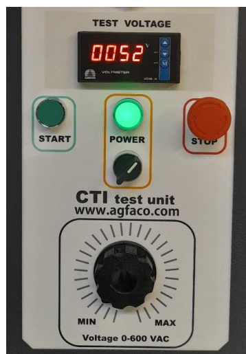
شکل ۱۳: نحوه تنظیم ولتاژ و قرائت آن
