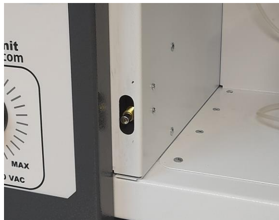
شکل ۱۴: شاسی قطع برق سیستم در هنگام بستن درب محفظه
