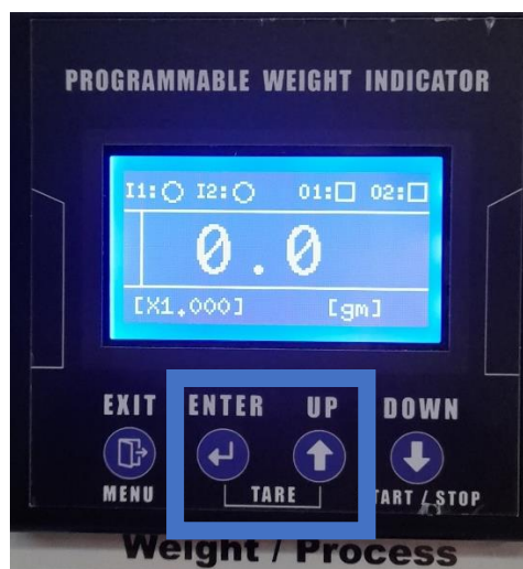
شکل ۶: نحوه صفر کردن ترازوی دیجیتال با کلید TARE
